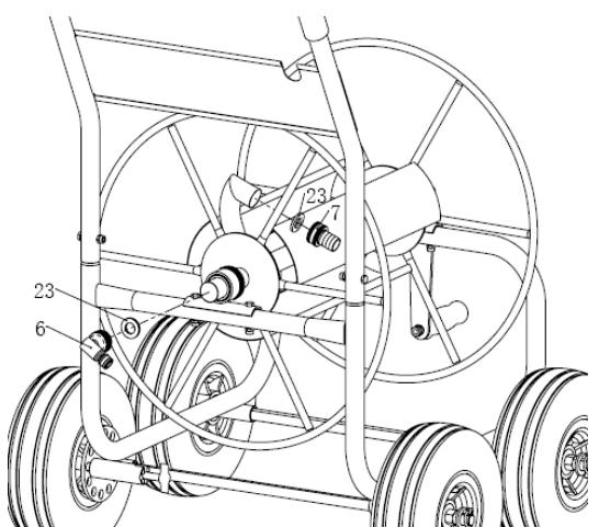
8. Positionnez le raccord mâle de sortie (7) comme indiqué, placez le joint en caoutchouc (23), serrez à la main ou avec une clé.
