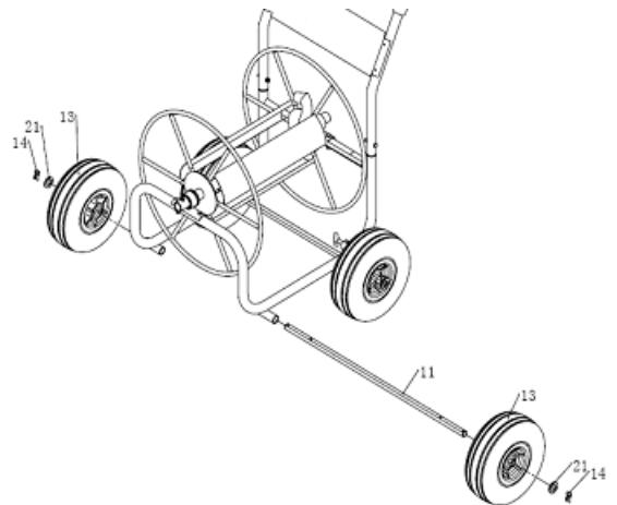
5. Insérez les roues (13). Fixez-les roues avec des rondelles Ø16 (21), et les goupilles de sécurité (14).
