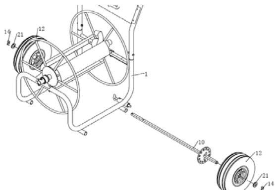
4. Insérez l'autre axe de roues (11) dans les logements prévus de chaque côté à l'avant du châssis.
