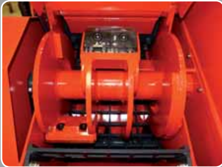
Rotor diamètre 600 mm – 6 couteaux – grande masse de rotation
